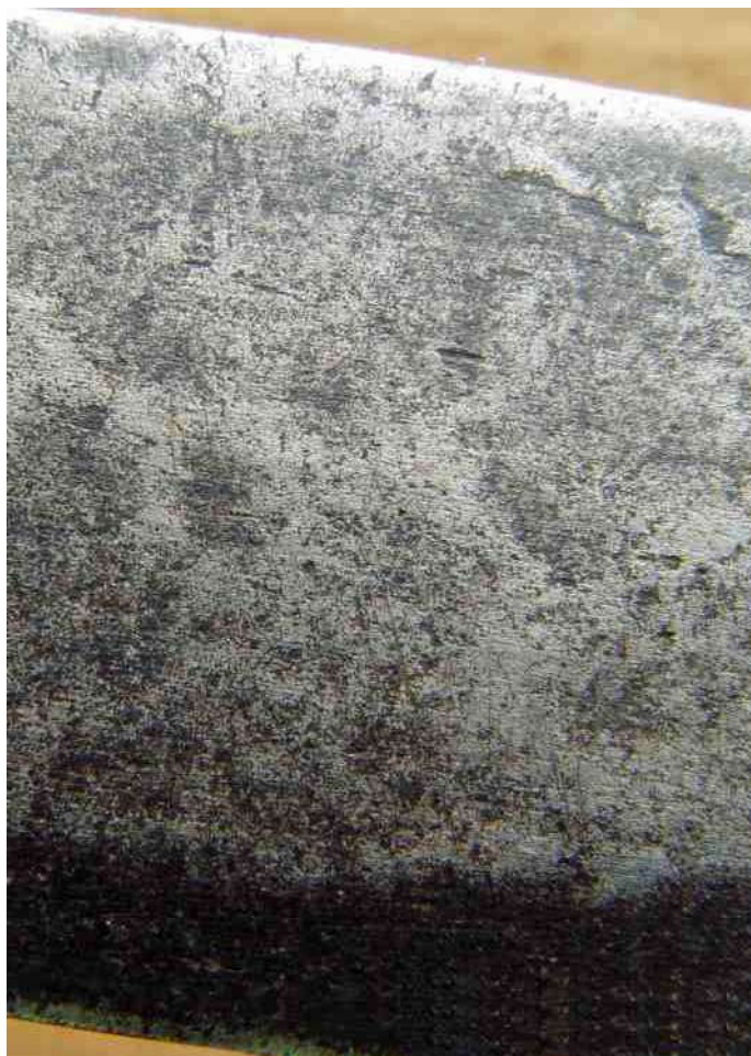
Azande sabel-mes, detail 4,5x uitvergroot : putjes en andere onregelmatigheden zijn duidelijk te zien
