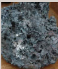
Een brok ijzer uit een laagoven, de wolf, in afgekoelde toestand.
