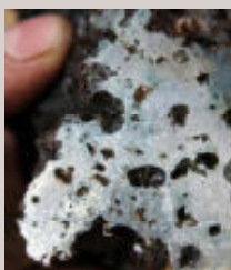
De doorgeslepen wolf. De verontreinigingen zijn zichtbaar als grijze insluitsels, gaten zijn zwart.
