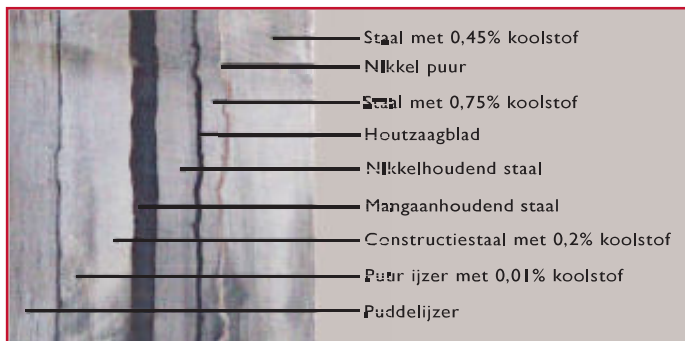
Een voorbeeld van aaneengewelde materialen. Let op de insluitsels die nog te zien zijn in het puddel-ijzer. (Macro-opname S. Visser)
