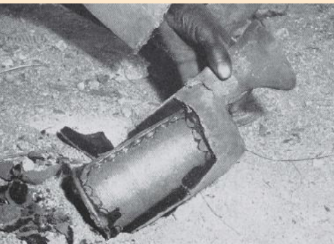
3. De kleimal wordt stuk geslagen en de messing enkelband wordt zichtbaar. Bovenaan is de van klei gemaakte trechter zichtbaar waarin de gesmolten messing gegoten is.
