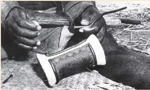
2. Het wasmodel is bijna gereed. Op de schoot van de smid is de plank te zien waarop de was wordt uitgerold.
