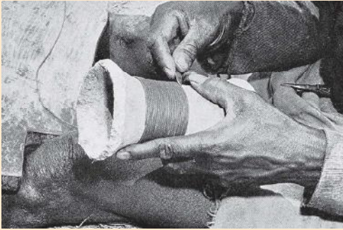
1. Dunne wasdraden worden rond de kleimal aangebracht.
